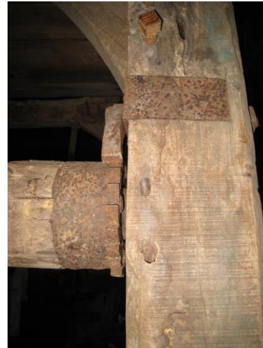
Roue à cliquet de réglage du rouleau de droite(absent à gauche)
