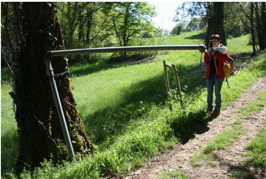
Dispositif articulé destiné à remplir une citerne mobile alimenté par le bassin
