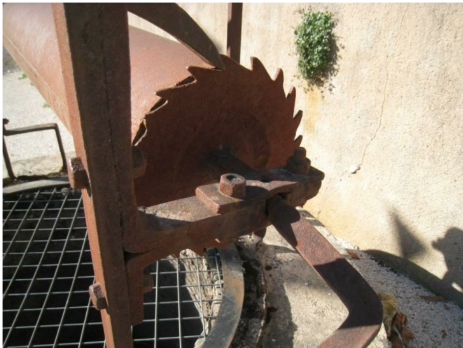
Palier droit du tambour et roue à rochet
